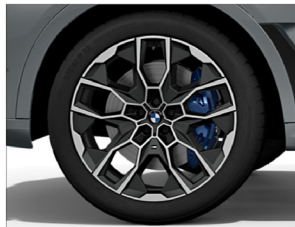
22 吋 M 雙輻式 913M 型輪圈 / M 煞車套件 (藍色) 輪圈：9.5J x 22 / 10.5J x 22 輪胎：275 / 40 R22 315 / 35 R22
