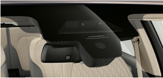
標準配備的遠光燈輔助系統會依據對向來車或前方車輛自動調整頭燈，為駕駛提供良好的夜間照明。在光線充足的環境下，例如鬧區，遠光燈輔助系統會自動關閉遠光燈。
