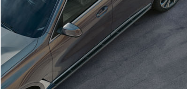
鋁合金登車踏板表面經陽極刷面處理，橡膠防滑飾條除了為外觀增添獨特質感，也讓進出車輛時更為便利。
