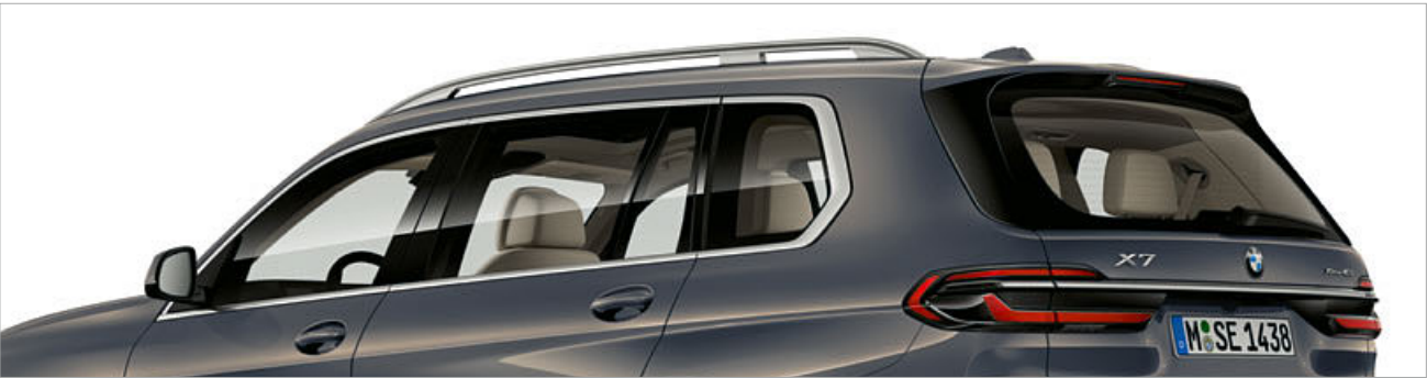
後側車窗的遮陽捲簾可電動開關。其可避免陽光直曬車內，並保護乘客隱私。 兩側車窗與後擋顏色較深的隔熱玻璃可減緩車內的高溫悶熱。
