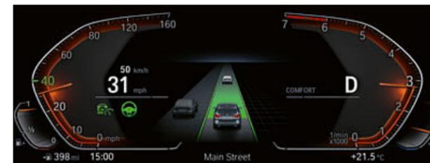
■ 自動停車輔助系統<sup>2</sup>讓停車更加輕鬆。倒車輔助攝影機和自動倒車輔助系統能在駕駛倒車時提供支援。主動式前後方停車警示系統可提供更好的防護，以避免停車所造成之損傷。自動停車輔助系統可自動執行橫向停車或縱向停車，亦可從路邊停車位駛離。
