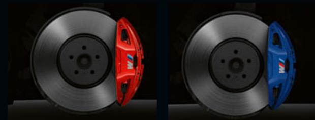
■ 強大的 M 煞車套件不僅可匹配車輛的高度動態潛能，更可接受極為運動化的駕駛風格，同時具備絕佳的煞車性能。固定式卡鉗採用專屬紅色高光澤搭配 M 標誌，成為醒目的視覺焦點。前鋁質煞車卡鉗上各配有四個活塞，後浮動式卡鉗則各有一個活塞。採用內通風設計與輕量化的特大尺寸煞車碟盤，可確保車輛具備出色的煞車性能。<sup>2</sup>
