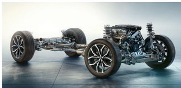
■ 電子懸吊系統可依各種行駛狀況調整阻尼器特性，進而提升傾斜舒適度和動態駕駛表現。除了可提升駕駛舒適度的標準 COMFORT 舒適設定外，亦可選擇採用運動風格阻尼器設定的 SPORT 運動程式。
