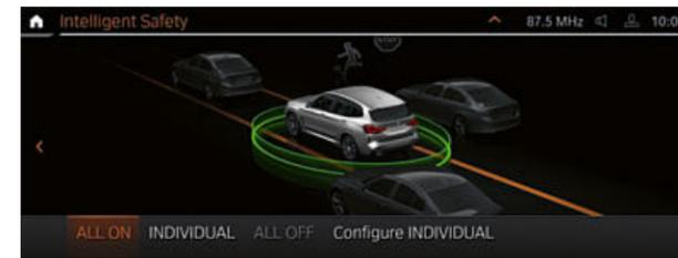
■ 輔助模擬畫面可提供由各個輔助系統所收集的車輛周遭環境即時資訊。藉由儀錶內的動態 3D 畫面，您可以清楚地看見車輛對於目前交通狀況的反應，進而了解各系統的運作方式。
