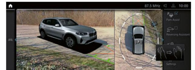
■ 進階自動停車輔助系統<sup>2</sup>讓停車與操控車輛更加輕鬆。其配備包括含俯視功能、全景畫面、遠端 3D 監控的 360 度環景輔助攝影，以及路邊停車輔助、具緊急煞車功能的主動式前後方停車警示系統、含縱向與橫向指引功能和自動倒車輔助系統的自動停車輔助系統。
