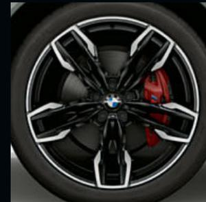
■ 20 吋 M 雙輻式 699 M 型雙色輕合金輪圈，搭配前後不同尺寸的輪胎和失壓續跑胎，拋光效果，前輪規格 8J x 20，搭配 245/45 R20 輪胎，後輪規格 9.5J x 20，搭配 275/40 R20 輪胎。
