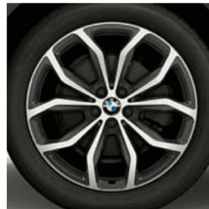
■ 20吋Y幅式695型雙色輕合金輪圈，搭配前後不同尺寸的輪胎，拋光效果，前輪規格8J x 20，搭配245/45 R20輪胎，後輪規格9.5J x 20，搭配275/40 R20輪胎。
