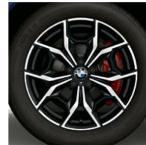
■ 19吋M雙幅式887M型雙色輕合金輪圈，輪圈規格7.5J x 19，搭配245/50 R19輪胎。
