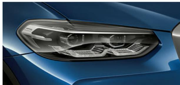
■ LED 主動式轉向頭燈包含近光燈和防眩遠光燈，以及全 LED 方向燈。此配備亦包含過彎燈、日間行車燈和主動式轉向頭燈，透過各種燈光控制，為前方道路提供出色照明，並為夜間行車提供更清晰的視野。
