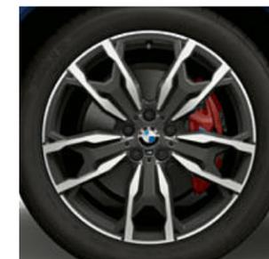
■ 20 吋 M 雙輻式 787 M 型輕合金輪圈，搭配前後不同尺寸的輪胎，拋光效果，前輪規格 8J x 20，搭配 245/45 R20 輪胎，後輪規格 9.5J x 20，搭配 275/40 R20 輪胎。<sup>3</sup>
