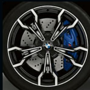
■ 21 吋 M V 輻式 765 M 型雙色輕合金輪圈，搭配前後不同尺寸的輪胎，拋光效果，前輪規格 9.5J x 21，搭配 255/40 ZR21 輪胎，後輪規格 10J x 21，搭配 265/40 ZR21 輪胎。
