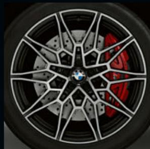
■ 21 吋 M 雙輻式 892 M 型雙色輕合金鍛造輪圈，搭配前後不同尺寸的輪胎，前輪規格 9.5J x 21，搭配 255/40 ZR21 輪胎，後輪規格 10J x 21，搭配 265/40 ZR21 輪胎。<sup>3</sup>
