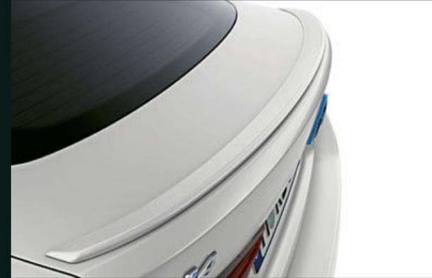
■ 與車身同色的 M 擾流尾翼不僅可凸顯車輛的動感輪廓，更可降低不必要的上升力。藉由對後軸產生下壓力，可提高車輛的行駛穩定性。
