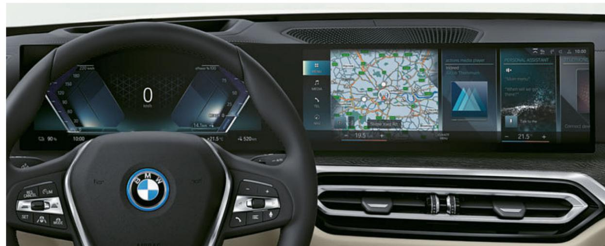
■ 全數位虛擬座艙包含一具無邊框的一體式曲面螢幕，其結合了 12.3 吋虛擬數位儀錶和 14.9 吋中控觸控螢幕。此外，相關資訊會透過 BMW 車況抬頭顯示器投射至擋風玻璃上。
