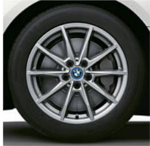
■ 17吋空氣力學852型雙色輪圈，拋光效果，輪圈規格7.5Jx17，搭配225/55 R17輪胎。<sup>1</sup>
