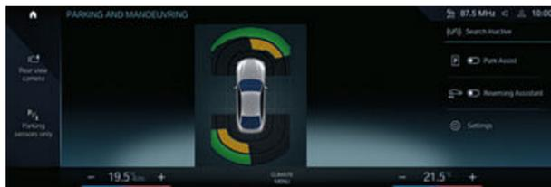
■ 當駕駛以低於每小時 20 公里的車速倒車時（例如停車時），倒車輔助攝影機能提供更清楚的方向指引，在中控觸控螢幕上顯示 BMW 座車後方的區域。進行車輛操控時，互動式導引線可協助測量距離和顯示轉向弧度，且會以顏色標出需避開的障礙物。
