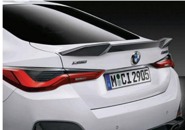
■ 碳纖維後擾流尾翼不僅可強化車輛整體的運動化外觀，更可確實產生下壓力，增加高速行駛時的車身穩定度。
