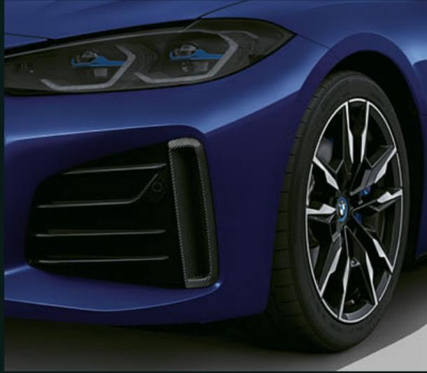
■ M 碳纖維外觀套件可凸顯車輛的運動需求。前保險桿側邊的擾流元件和 M 後視鏡蓋均以碳纖維複合材質 (CFRP) 製成。車尾兩側的飾條和特殊造型的擾流尾翼讓此套件更臻完美。
