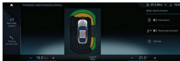
■ 路邊停車輔助是前後方停車警示系統的一部分，可在您操控時提供車輛周遭的「全方位視野」。如此一來，便能偵測到車輛兩側的障礙物並發出聽覺與視覺訊號。
