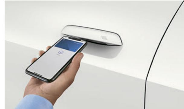
■ BMW 手機數位鑰匙<sup>1</sup> 讓您可將相容的智慧型手機設為車輛鑰匙。只需將智慧型手機靠近車門把手即可解鎖；將其置於智慧型手機座上，即可啟動您的 BMW 座車。此外，您可將手機數位鑰匙傳送給多達五名親友，甚至能限制最高車速等，非常適合新手駕駛。
