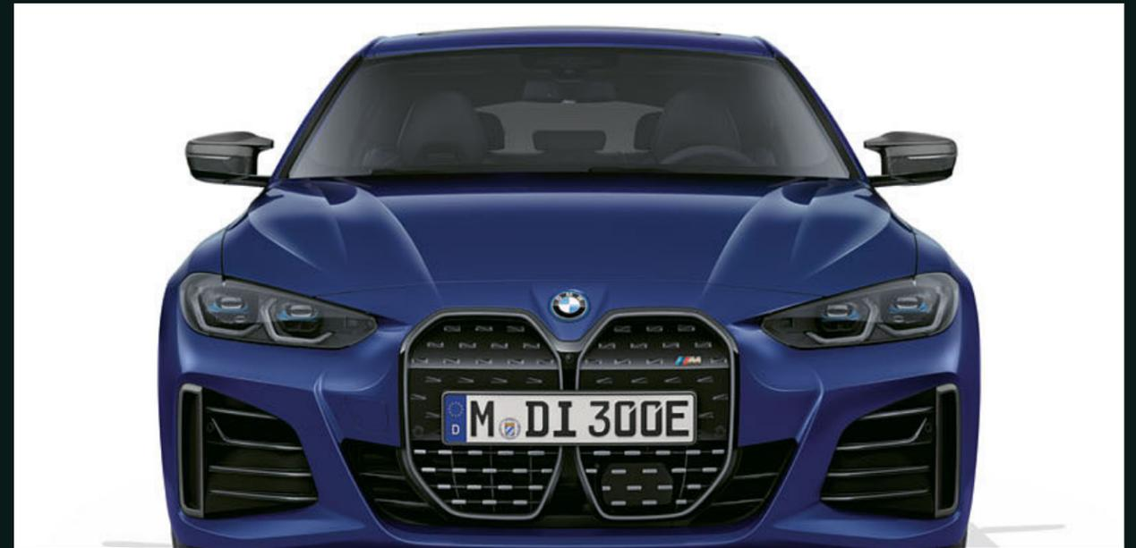
■ 含其他配件的 M high-gloss Shadow Line 黑色高光澤窗框包含黑色高光澤雙腎型水箱護罩邊框。i4 M50 亦包含黑色高光澤的前保險桿兩側擾流元件和 M 後視鏡蓋。
