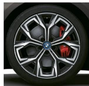
■ 19吋MY輻式859M型雙色輪圈，搭配前後不同尺寸的輪胎，拋光效果，前輪規格8.5Jx19，搭配245/40 R19輪胎，後輪規格9Jx19，搭配255/40 R19輪胎。<sup>2</sup>
