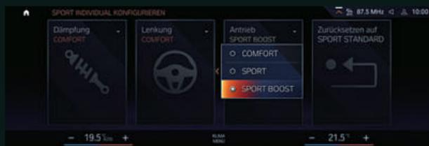
■ 在 SPORT BOOST 模式下，BMW M eDrive 電動馬達能額外提供高達 68 匹馬力 (50 kW) 的動力。在此情況下，驅動系統對加速指令的反應將更為靈敏。您可明顯感受此強化功能可提供更強大的動力輸出，進而創造出獨特、跑車化的駕駛體驗。
