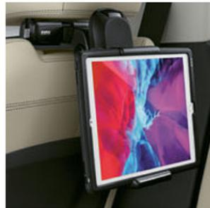
■ 為使用 BMW 保護殼的平板電腦提供穩固支撐。可調整的固定架安裝於固定座或旅行便利套件 (選用配備)。
