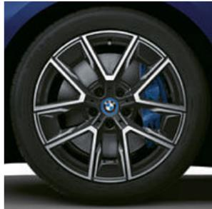
■ 19吋空氣力學855型雙色輪圈，拋光效果，前輪規格8.5Jx19，搭配245/40 R19輪胎，後輪規格9Jx19，搭配255/40 R19輪胎。<sup>1</sup>
