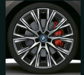
■ 20 吋 BMW Individual 空氣力學 862 I 型雙色輪圈，拋光效果，前輪規格 8.5J x 20，搭配 245/35 R20 輪胎，後輪規格 9J x 20，搭配 255/35 R20 輪胎。
