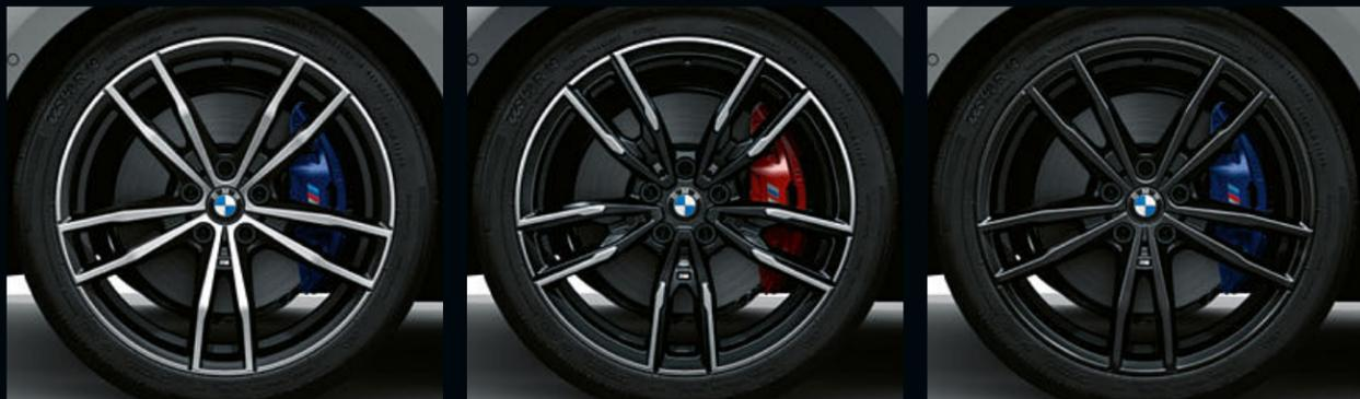
19 吋 M 雙輻式 791 M 型雙色輕合金輪圈，搭配性能胎和前後不同尺寸的輪胎，拋光效果，前輪規格 8J x 19，搭配 225/40 R19 輪胎，後輪規格 8.5J x 19，搭配 255/35 R19 輪胎。
