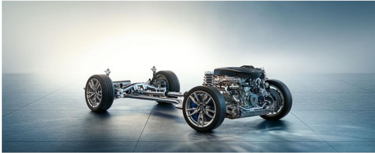
M 跑車化懸吊系統<sup>1</sup>將懸吊系統高度降低 10 公釐，具備運動風格的懸吊系統設定與更硬明的阻尼器設定，並具備稍高的彈簧常數和較為硬朗的防傾桿。綜合上述特色，創造出更直接的懸吊設計，帶來更具運動感的駕駛風格。
