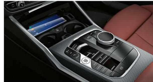
手機無線充電裝置以高達 15 瓦的功率便利地為您的智慧型手機進行無線充電。整合式冷卻功能可防止過熱。
