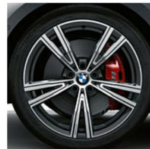
19 吋 BMW Individual 雙輻式 793 I 型雙色輕合金輪圈，搭配前後不同尺寸的輪胎和失壓續跑胎，拋光效果，前輪規格 8J x 19，搭配 225/40 R19 輪胎，後輪規格 8.5J x 19，搭配 255/35 R19 輪胎。
