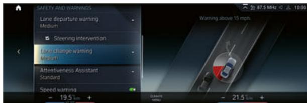
駕駛輔助套件<sup>2</sup>能在危急的行駛狀況下提供支援。如有需要，此安全性套件會自動煞車以避免追撞。其亦能在不小心偏離車道時發出警示，並主動引導 BMW 座車返回原車道。若追撞即將發生，其會啟動安全防護措施，並警示後方車輛減速。
