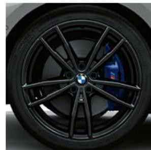
19 吋 M 雙輻式 791 M 型輕合金輪圈，搭配性能胎和前後不同尺寸的輪胎，拋光效果，前輪規格 8J x 19，搭配 225/40 R19 輪胎，後輪規格 8.5J x 19，搭配 255/35 R19 輪胎<sup>1</sup>。
