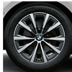
17 吋 V 輻式 775 型雙色輕合金輪圈，拋光效果，輪圈規格 7.5J x 17，搭配 225/50 R17 輪胎。
