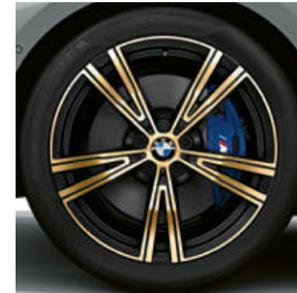
19 吋 BMW 雙輻式 793 型雙色輕合金輪圈，具拋光效果。完整夏季輪圈組，配備胎壓偵測器，且搭配失壓續跑胎。
