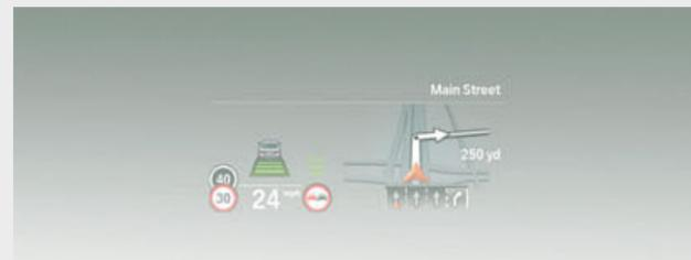
■ 大尺寸的彩色 BMW 車況抬頭顯示器<sup>1</sup>會將旅程相關資訊直接投射在您的視線範圍內，讓您能完全專注於前方路況。視配備而定，可顯示目前車速、導航提示、含禁止超車指示的速限資訊，以及電話和娛樂清單等功能。
