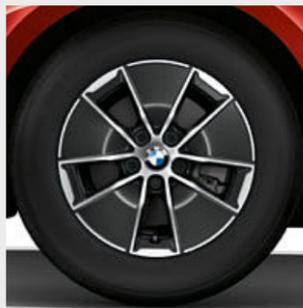
■ 16 吋 773 型渦輪式 Orbit Grey 雙色輕合金輪圈，BMW EfficientDynamics 高效動力，光澤效果，輪圈規格 6.5J x 16，搭配 205/60 R16 輪胎。
