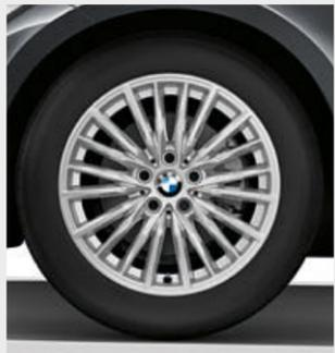
■ 17 吋 771 型雙輻式 Reflex Silver 輕合金輪圈，輪圈規格 7.5J x 17，搭配 225/50 R17 輪胎。
