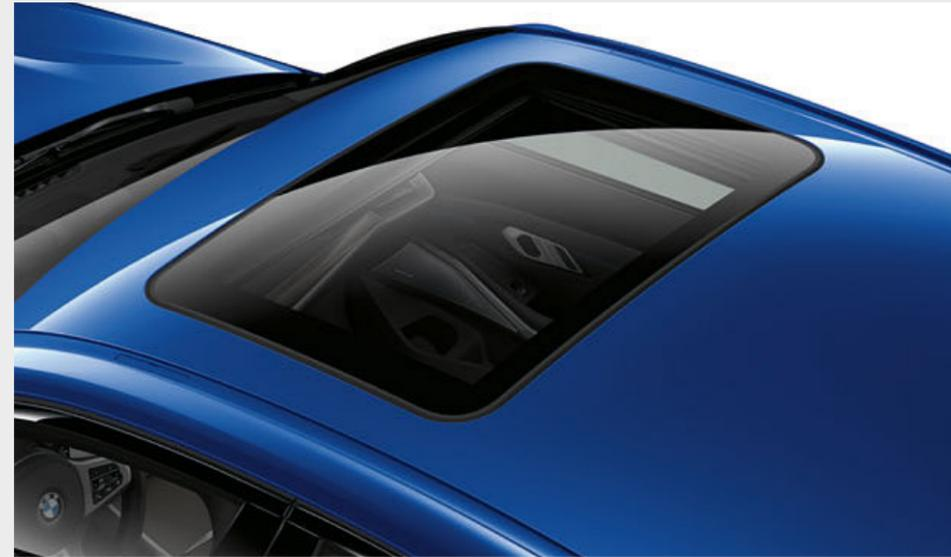
■ 配備滑動及上掀功能的玻璃天窗，包含防夾保護以及輕鬆啟閉功能，可調整氣流，營造舒適的車內環境。整合式擾流板可防止車內氣流擾動，並降低風切聲。
