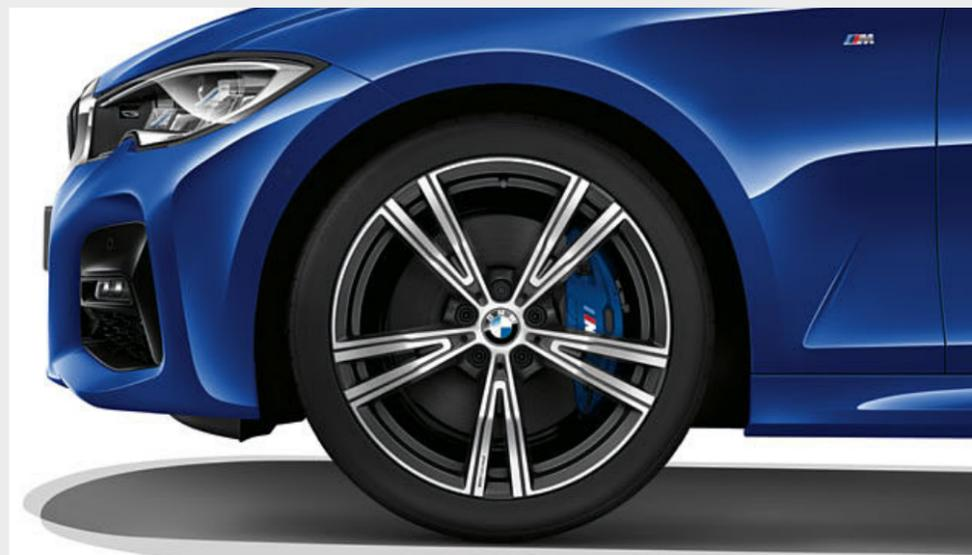
■ M 款 19 吋 791 M 型雙輻式 Jet Black 雙色輕合金輪圈，搭配前後不同尺寸的輪胎和失壓續跑胎，拋光效果，前輪規格 8J x 19，搭配 225/40 R19 輪胎，後輪規格 8.5J x 19，搭配 255/35 R19 輪胎。<sup>2</sup>
