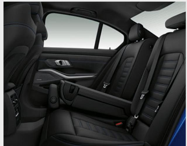
■ 40/20/40 分離可傾倒後座椅背能提供最大彈性的空間運用。例如，載運雪機和滑雪板袋等長型物品時，後座仍可提供兩名乘客舒適乘坐。中央扶手上的兩個置杯架也非常實用。
