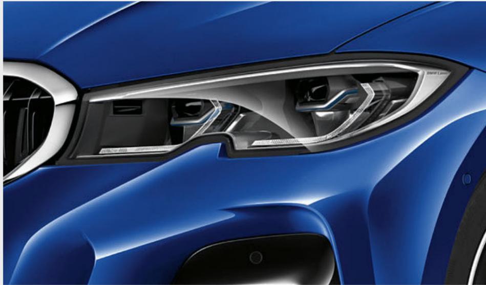
■ 在雷射遠光燈模式中，智慧雷射頭燈的照明範圍可達 600 公尺，相當於傳統頭燈的兩倍。於夜晚提供更好的能見度，可大幅提升安全性。頭燈內的藍色飾條與「BMW Laserlight」字樣不僅凸顯其科技水準，也為車輛外觀增添動感。
