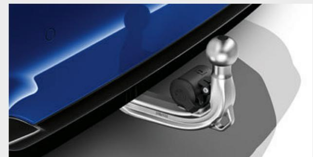
■ 視引擎而定，含電動調整拖車球的拖車鉤最高可負重 1,800 公斤。為保持穩定，當拖車開始擺動時，拖車穩定控制系統便會自動進行煞車。電動調整拖車球可收納於後下擾流板下方並完全隱藏。(台灣地區可能不適用) 配備的詳細資訊。
