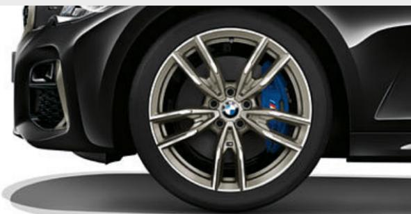
■ M 款 19 吋 792 M 型雙輻式鈦灰色雙色輕合金輪圈，搭配前後不同尺寸的輪胎和失壓續跑胎，拋光效果，前輪規格 8J x 19，搭配 225/40 R19 輪胎，後輪規格 8.5J x 19，搭配 255/35 R19 輪胎。<sup>1</sup>
