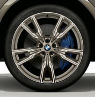
■ M 款 22 吋 747 M 型 V 輻式鈹灰色霧面輕合金輪圈，搭配前後不同尺寸的輪胎，拋光效果，前輪規格 9.5J x 22，搭配 275/35 R22 輪胎，後輪規格 10.5J x 22，搭配 315/30 R22 輪胎。 5
