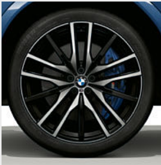
■ M 款 22 吋 742 M 型雙輻式 Jet Black 雙色輕合金輪圈，搭配前後不同尺寸的輪胎，拋光效果，前輪規格 9.5J x 22，搭配 275/35 R22 輪胎，後輪規格 10.5J x 22，搭配 315/30 R22 輪胎。
