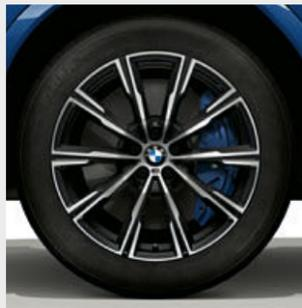
■ M 款 20 吋 740 M 型星輻式 Orbit Grey 雙色輕合金輪圈，搭配前後不同尺寸的輪胎和失壓續跑胎\*，拋光效果，前輪規格 9J x 20 搭配 275/45 R20 輪胎，後輪規格 10.5J x 20 搭配 305/40 R20 輪胎。<sup>2</sup>
