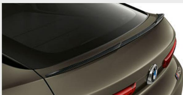
■ M 碳纖維<sup>1</sup>\*擾流尾翼能凸顯車輛強大、充滿運動感的設計，並有效減少後軸上不必要的空氣力學升力。
