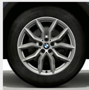
■ 19 吋 734 型 V 輻式 Reflex Silver 輕合金輪圈\*，輪圈規格 9J x 19 搭配 265/50 R19 輪胎。
