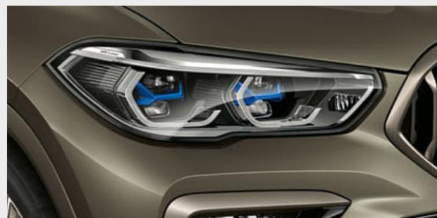
■ 在雷射遠光燈模式中，採用獨特 X 設計的智慧雷射頭燈照明範圍可達 500 公尺，相當於傳統頭燈的兩倍。在黑暗中擁有更高的能見度，可大幅提升安全性。以藍色 X 標誌與「BMW Laser」字樣突顯車輛的技術標準。
