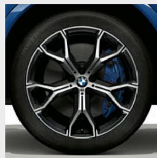
■ M 款 21 吋 741 M 型 Y 輻式 Orbit Grey 雙色輕合金輪圈，搭配前後不同尺寸的輪胎，拋光效果，前輪規格 9.5J x 21 搭配 275/40 R21 輪胎，後輪規格 10.5J x 21 搭配 315/35 R21 輪胎。<sup>2,3</sup>
