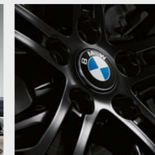
■ 懸浮定軸輪圈中心蓋具有一個能保持水平、不隨輪圈轉動的 BMW 標誌。
