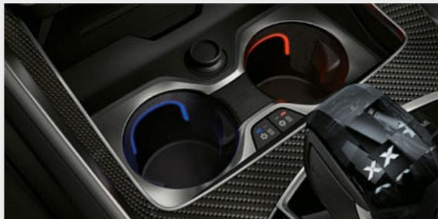
■ 中央鞍座內的冷熱恆溫功能前置杯架可對飲料個別進行保冷或保溫。可藉由左右兩側的按鈕啟動溫度控制。置杯架中的氣氛燈也能顯示目前的使用情況 (藍色代表保冷，紅色代表保溫)。
