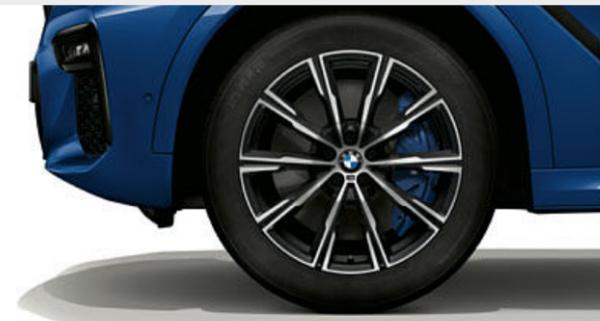
■ M 款 20 吋 740 M 型星輻式 Orbit Grey 雙色輕合金輪圈，搭配前後不同尺寸的輪胎和失壓續跑胎，拋光效果，前輪規格 9J x 20 搭配 275/45 R20 輪胎，後輪規格 10.5J x 20 搭配 305/40 R20 輪胎。
