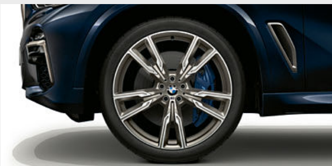
■ M 款 22 吋 747 M 型 V 輻式輕合金輪圈，霧面 Cerium Grey 搭配前後不同尺寸的輪胎，拋光效果，前輪規格 9.5J x 22，搭配 275/35 R22 輪胎，後輪規格 10.5J x 22，搭配 315/30 R22 輪胎。 3,5
