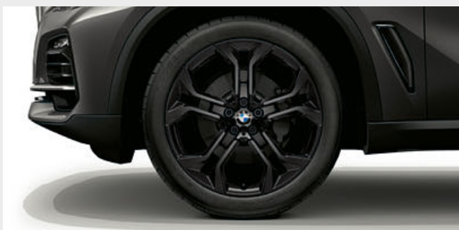
■ 21 吋 744 型 Y 輻式輕合金輪圈，Orbit Grey 搭配前後不同尺寸的輪胎及失壓續跑胎，前輪規格 9.5J x 21，搭配 275/40 R21 輪胎，後輪規格 10.5J x 21，搭配 315/35 R21 輪胎。 1,5,*
