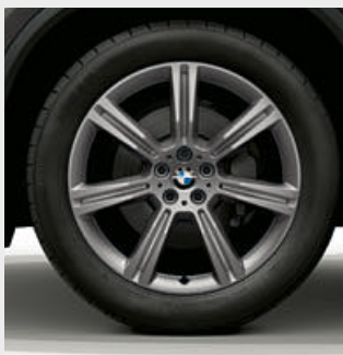
■ 20 吋 736 型星輻式輕合金輪圈，雙色 Ferric Grey 搭配前後不同尺寸的輪胎及失壓續跑胎，前輪規格 9J x 20，搭配 275/45 R20 輪胎，後輪規格 10.5J x 20，搭配 305/40 R20 輪胎。 5,6
