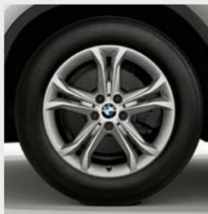
18 吋 688 型雙輻式輕合金輪圈，Reflex Silver，輪圈規格 7J x 18，搭配 225/60 R18 輪胎。
