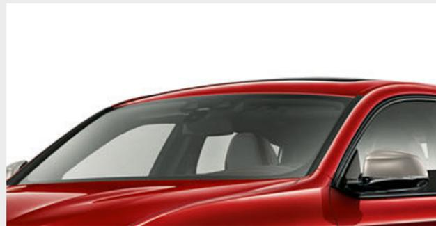
淺色的遮陽 / 隔熱玻璃可反射部分陽光輻射，防止車內溫度過高。前座玻璃和擋風玻璃抗噪設計，能讓乘客以低音量更輕鬆交談。
