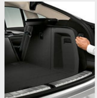
快速釋放後座椅背，可透過行李廂的控制桿傾倒後座椅背。
