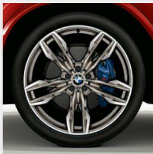
M 款 21 吋 718 M 型雙輻式輕合金輪圈，Cerium Grey 雙色霧面，拋光效果，搭配前後不同尺寸的失壓續跑胎，前輪規格 8.5J x 21，搭配 245/40 R21 輪胎，後輪規格 9.5J x 21，搭配 275/35 R21 輪胎。
