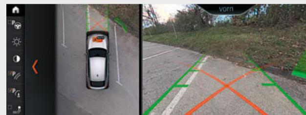
進階自動停車輔助系統<sup>4</sup>讓停車與操駕更加輕鬆。它包含環景顯示系統含俯視功能、遠端 3D 監控、前後方停車警示系統與橫向停車輔助、主動式前後方停車警示系統、緊急煞車功能以及自動停車輔助系統含輔助線指引，可執行全自動的路邊停車及倒車入庫。
