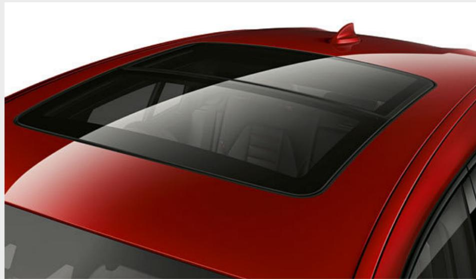
打開全景式電動玻璃天窗時，可為車內導入新鮮自然的空氣。關上時也能為車內帶來明亮且光線充足的氛圍。只要按下按鈕或使用車鑰匙就能完全自動啟閉，並配備滑動和上掀功能、遮陽捲簾與擾流板。
