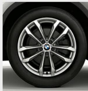
19 吋 691 型 V 輻式 Reflex Silver 輕合金輪圈，輪圈規格 7.5J x 19，搭配 245/50 R19 輪胎。
