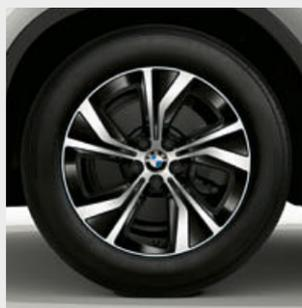
18 吋 689 型渦輪式輕合金輪圈，雙色 Jet Black 標準漆，光澤效果，BMW EfficientDynamics 高效動力科技，輪圈規格 7J x 18，搭配 225/60 R18 輪胎。
