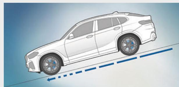
**HDC 陡坡緩降控制系統**啟動後，當行駛在陡峭的下坡路段時，能確保車輛會自動且安全地緩步滑行，駕駛人甚至不需踩煞車。
