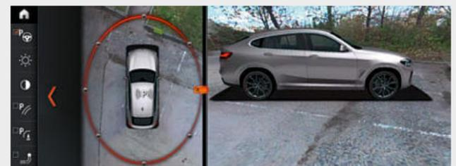
環景顯示系統包含攝影機偵測式倒車顯示系統、全景功能、俯視功能、3D 監控與遠端 3D 監控功能。車外後視鏡中及車輛前後的攝影機可提供 360° 的環景畫面。全景畫面可讓進出口與車道時更加安全。在控制顯示螢幕上顯示車輛左右方交通狀況，提供更清晰的視野。
