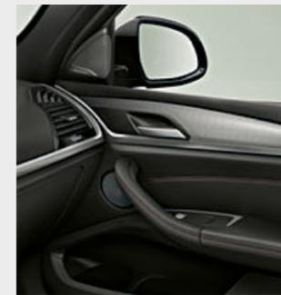
Harman Kardon 環場音響系統，具 600 瓦數位擴音器、車用音響等化器與揚聲器。
