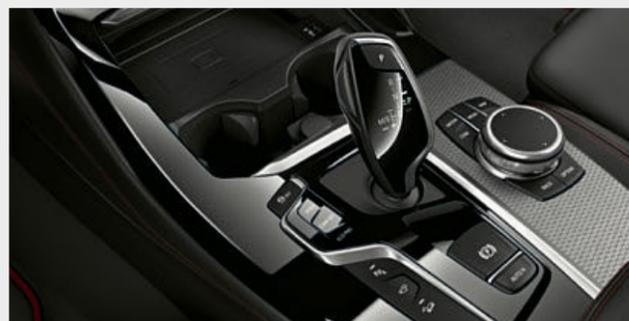
Steptronic 運動化八速手自排變速系統，提供運動感十足的換檔體驗。不論是透過換檔撥片或排檔桿進行自動或手動換檔，都能讓車輛舒適地滑行或展現優異的動態駕駛特性。在 SPORT 運動模式中，排檔桿若位於左側的 S/M 位置，變速系統將發揮極致性能表現。
