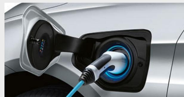
高壓電池的外接充電埠位於車輛前方左側的護蓋後方。充電埠以特殊的密封保護，避免與其他零件接觸。周圍的 LED 光環可顯示車輛目前的充電狀態。
