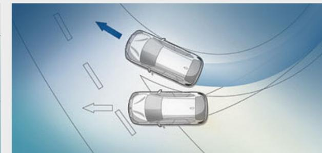
**DSC 動態穩定控制系統** 會以感測器持續評估車輛的移動狀態，並在偵測到行車狀態不穩時透過引擎與煞車調節穩定車身。輔助功能包含煞車待命功能、煞車自動乾燥功能與上坡起步輔助功能等。
