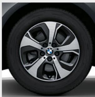
■ 16 吋 472 型渦輪式輕合金輪圈，BMW EfficientDynamics 高效動力，Orbit Grey，具光澤效果，輪圈規格 7J x 16，搭配 205/60 R16 輪胎。
