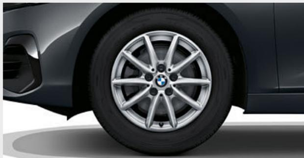
■ 16 吋 471 型 V 輻式 Reflex Silver 輕合金輪圈，輪圈規格 7J x 16 搭配 205/60 R16 輪胎。
