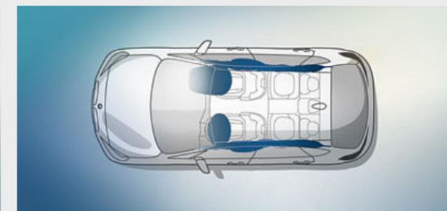
第一排與第二排座椅的**頭部空氣囊**讓車輛的空氣囊設備更加完善。其具備可阻擋亂飛之尖銳物品的防護片，可在車窗區域形成有效的頭部保護系統，亦可在發生側面撞擊時為後座乘客提供防護。
