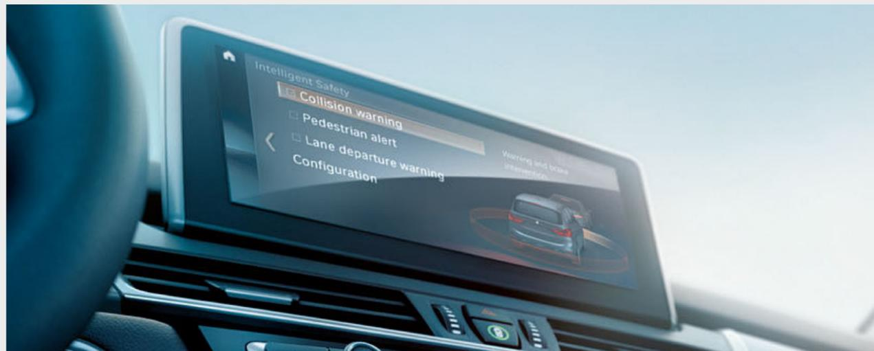
駕駛輔助套件屬於安全性套件，包含車道偏離警示、主動防撞輔助系統、遠光燈輔助系統等攝影偵測式輔助系統。主動防撞輔助系統與行人偵測功能可在時速介於 10 到 60 公里時發出警示，以避免發生碰撞，在時速超過 70 公里時，車道偏離警示功能會在車輛不慎偏離車道時震動方向盤，以提醒駕駛。
