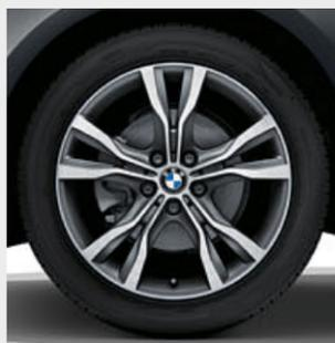
■ 18 吋 484 型 Y 輻式 Ferric Grey 輕合金輪圈，拋光效果，輪圈規格 8J x 18 搭配 225/45 R18 輪胎。
