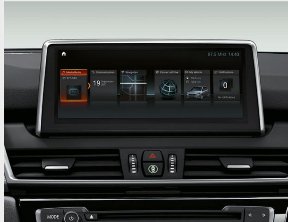
Navigation Plus 包含 BMW 車況抬頭顯示器、iDrive 手寫觸控旋鈕、內建 8.8 吋觸控螢幕和搭載高解析度的 5.7 吋 TFT 螢幕的儀錶。系統可藉由 iDrive 手寫觸控旋鈕、直接選單控制鍵和六或八個功能快捷鍵、智慧型語音控制或含互動磚的觸控螢幕進行直覺式操作。
