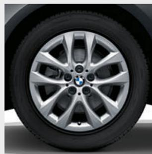
■ 17 吋 479 型 V 輻式 Reflex Silver 輕合金輪圈，輪圈規格 7.5J x 17 搭配 205/55 R17 輪胎。
