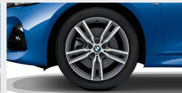
■ M 款 18 吋 486 M 型雙輻式輕合金輪圈搭配失壓續跑胎，輪圈規格 8 J x 18，搭配 225/45 R18 輪胎。
