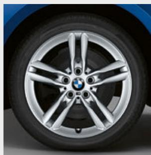
■ M 款 17 吋 483 M 型雙輻式輕合金輪圈，規格 7.5J x 17，搭配 205/55 R17 輪胎。
