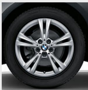
■ 17 吋 385 型雙輻式 Reflex Silver 輕合金輪圈，輪圈規格 7.5J x 17 搭配 205/55 R17 輪胎。
