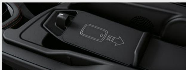
含無線充電功能<sup>2</sup>的電話系統包含一個無線充電座和額外的 USB 連接埠。連接至車頂天線可改善行動電話的收訊。透過藍牙可同時連接兩支行動電話和一個音樂播放器。此外，還有藍牙連線功能。
