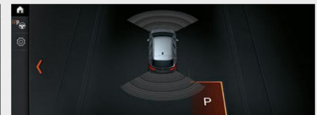
自動停車輔助系統<sup>5</sup>讓路邊停車更加輕鬆。系統會在低速行駛時沿路偵測可用的停車空間。偵測到足夠的空間時，自動停車輔助系統會接管轉向動作，您只需控制油門、檔位與煞車。
