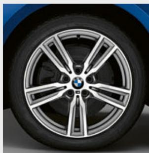
■ M 款 18 吋 486 M 型雙輻式 Ferric Grey 輕合金輪圈，具拋光效果，輪圈規格 8J x 18 搭配 225/45 R18 輪胎。
