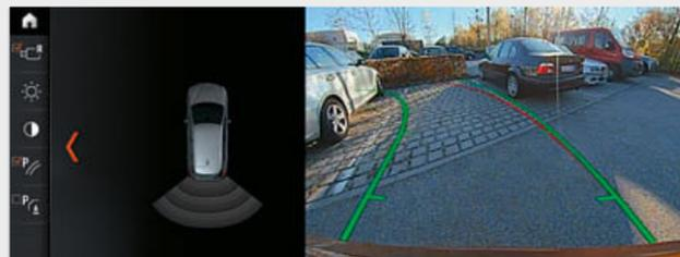
當駕駛人以低於 15 公里的時速倒車時 (例如停車時)，倒車攝影機可提供協助，並在控制顯示螢幕上顯示車輛後方區域。用來測量距離和轉向輔助的互動式引導線能協助您操控車輛。障礙物會以顏色標示。
