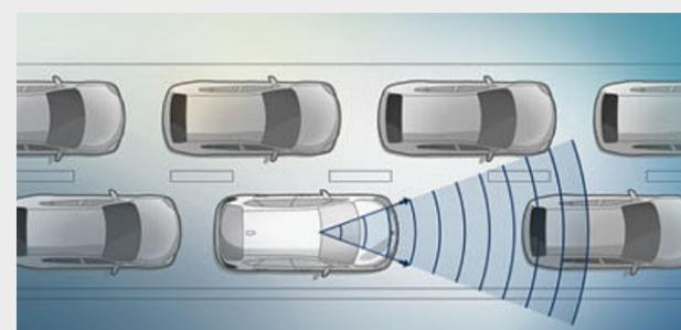
**壅塞交通輔助功能** 啟動後能在高速公路交通擁擠時減輕駕駛的負擔。當車速在 60 公里以下時，本系統會在壅塞路況下讓車輛隨其他車輛一同前進，減輕塞車時的壓力。系統會自動與前車保持距離，調整車速直到完全停下，同時提供轉向輔助。
