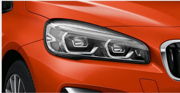
■ LED 主動式轉向頭燈，包括近光燈、遠光燈和整合式方向燈，均採 LED 科技。此配備包含遠光燈輔助系統、轉向輔助照明、日間行車燈和主動式轉向頭燈，透過多樣化的燈光控制，可為前方道路提供出色照明，使夜間行車時擁有更清晰的視野。
