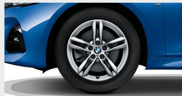
■ M 款 17 吋 483 M 型雙輻式輕合金輪圈，規格 7.5J x 17，搭配 205/55 R17 輪胎。
