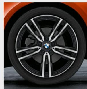
■ 充滿運動風格的 M 款 19 吋 766 M 型雙輻式輕合金輪圈採用 Jet Black 霧面雙色設計，具拋光效果、輕量化設計並配備 BMW M 標誌。TPMS 夏季完整輪圈組搭配失壓續跑胎，輪圈規格 8J x 19 搭配 225/40 R18 93Y RSC 輪胎。
