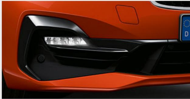
■ LED 霧燈提升了濃霧中的短距離能見度，增進行車安全性。霧燈所發出的光線顏色與日光非常接近。其所消耗的能源極低，且具備非常長的使用壽命。同時也為車頭增添科技感十足的現代風貌。
