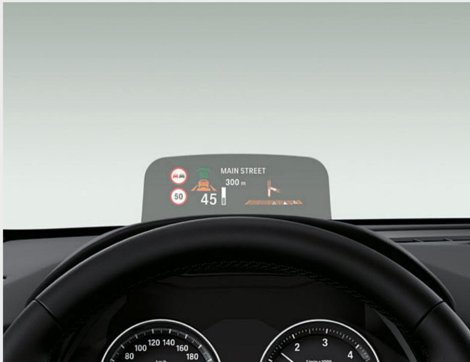
彩色的 BMW 車況抬頭顯示器<sup>1</sup>會將行車相關資訊投射在駕駛視線範圍內的面板上，讓駕駛能將注意力集中在前方路況。視搭載的配備而定，顯示內容包含目前車速、導航系統的方向提示、含禁止超車指示的速限資訊，以及電話和娛樂清單。
