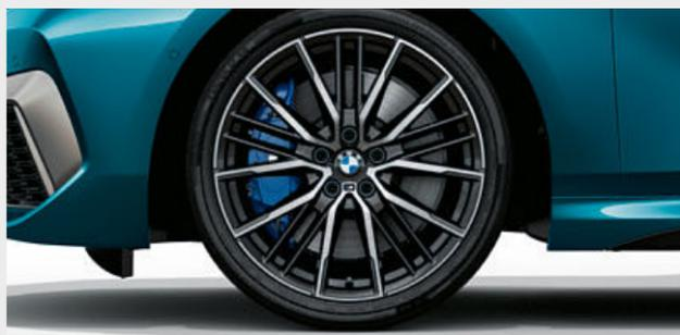
■ M 款 19吋 552 M 型雙輻式 Jet Black 雙色輕合金輪圈，拋光效果，輪圈規格 8J x 19，搭配 235/35 R19 輪胎。<sup>3</sup>
