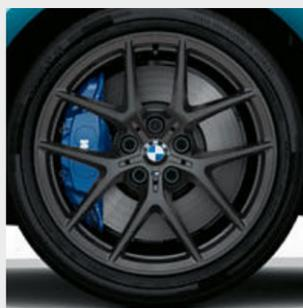
■ M 款 18吋 554 M 型 V 輻式 Orbit Grey 金屬漆輕合金輪圈，輪圈規格 8J x 18，搭配 225/40 R18 輪胎。<sup>3</sup>
