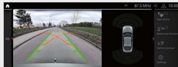
■ 自動停車輔助系統<sup>4,5</sup> 讓停車更加輕鬆。倒車攝影機能提供清晰的車後畫面。主動式前後方停車警示系統可提供更好的防護，以避免停車所造成之損傷。自動停車輔助系統可自動執行路邊停車或倒車入庫，亦可從路邊停車位駛離<sup>5</sup>。自動倒車輔助系統可在倒車時 (如在狹小巷道中) 提供協助。
