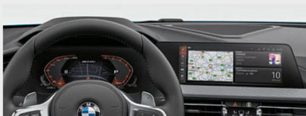
■ 含導航功能的全數位虛擬座艙包含兩個高品質的顯示螢幕，分別為高解析度的 10.25 吋中控觸控螢幕和 10.25 吋的虛擬數位儀錶。BMW ID7 介面亦可透過 iDrive 手寫觸控旋鈕操作。
