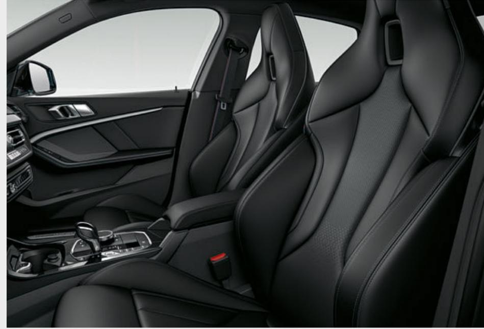
■ M 跑車座椅<sup>4</sup> 配備整合式頭枕、較低的坐墊，以及腿部和腰部加高的側墊，即使在高速過彎時也能為駕駛和前座乘客提供較好的支撐力。此外，整合式椅背寬度調整系統讓您可依照個人身形調整座椅。
