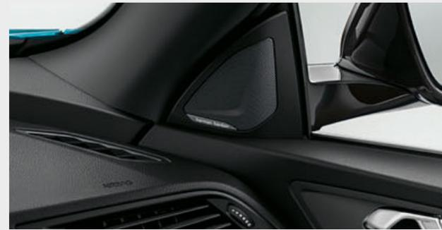
■ 出色的 Harman Kardon 高傳真音響系統配備 464 瓦的數位擴大機，且具備 9 聲道與 16 具揚聲器。車內將縈繞著極為和諧的完美音效。車用音響等化器會根據行車速度自動精準地補償所有背景中的行駛噪音。
