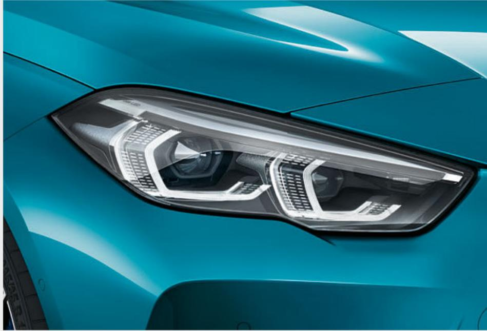
■ 智慧 LED 主動式轉向頭燈具備近光燈和遠光燈，包括防眩遠光燈輔助系統 (含 Glare-free 光形變化功能) 以及採用全 LED 科技的方向燈。此配備亦包含轉向輔助燈、日間行車燈和具備城市、鄉間和高速公路等模式的主動式轉向頭燈，可為前方道路提供出色照明。
