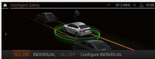
■ 屬於安全性套件的駕駛輔助科技<sup>3</sup> 包含多項以攝影機為基礎的系統：含主動防撞輔助系統與行人偵測和車道偏離警示。此外，以雷達為基礎的設備則包括後方車流警示、盲點偵測警示系統和後方防撞警示。
