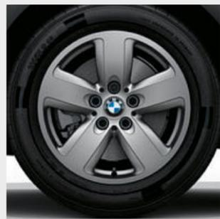
■ 16吋 517 型星輻式 Ferric Grey 輕合金輪圈，輪圈規格 7J x 16，搭配 205/55 R16 輪胎。
