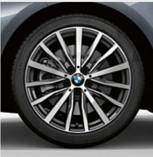
■ 18 吋 488 型多輻式 Orbit Grey 金屬漆雙色輕合金輪圈，拋光效果，輪圈規格 8J x 18，搭配 225/40 R18 輪胎。*
