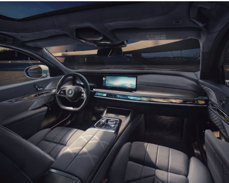
可調整色調的BMW環繞光幕，將座艙照明與控制介面進行整合，大幅降低實體按鍵的數量。
