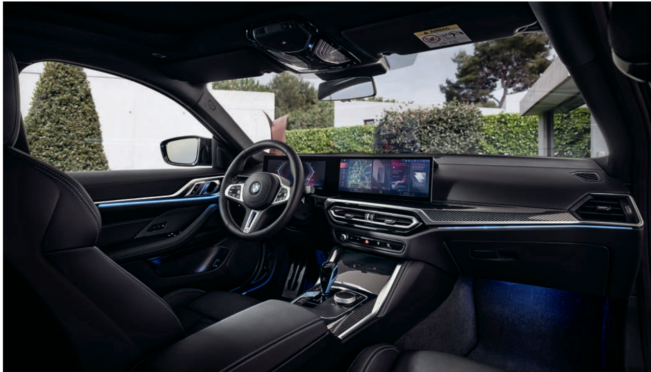
全新BMW i4 以一體式曲面螢幕整合了虛擬數位儀錶與中控觸控螢幕，導入BMW iDrive 8.0使用者介面，呈現清楚明瞭的行車資訊。
