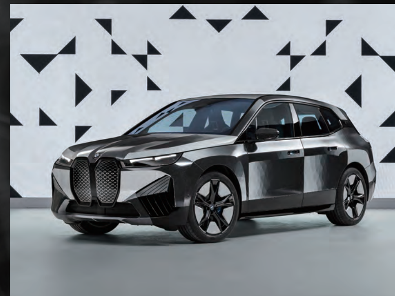
電子紙結合BMW的智慧設計演算法，可讓BMW iX Flow外觀車色以動態流動方式，在黑白色之間轉換。
