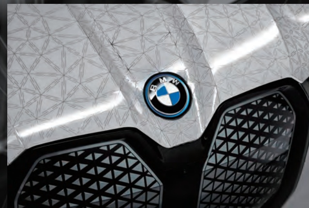
BMW研發團隊與元太科技密切合作，透過複雜的雷射切割，打造可精準貼合車體曲線的可變色電子紙。
